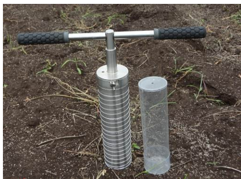
ヘリカル貫入式ソイルサンプラー ならびに透明円筒（φ80*300）
