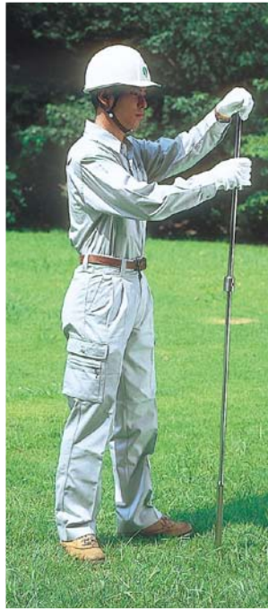
落錘を落とし採土部を土壌に貫入
