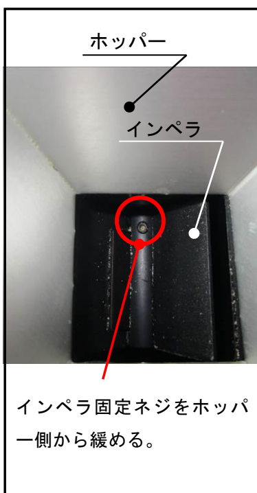
図2. インペラ固定ネジ
