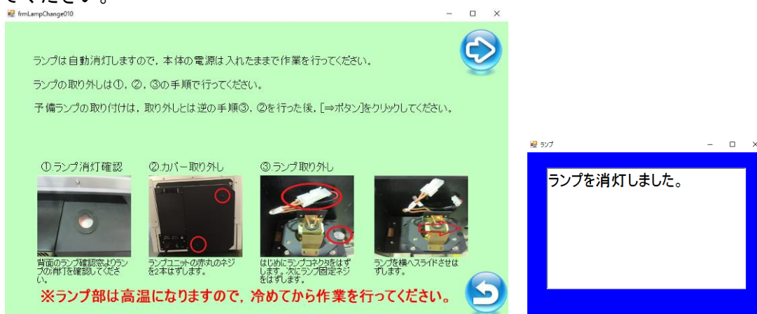
図 8.7.4.1 ランプ交換作業画面
