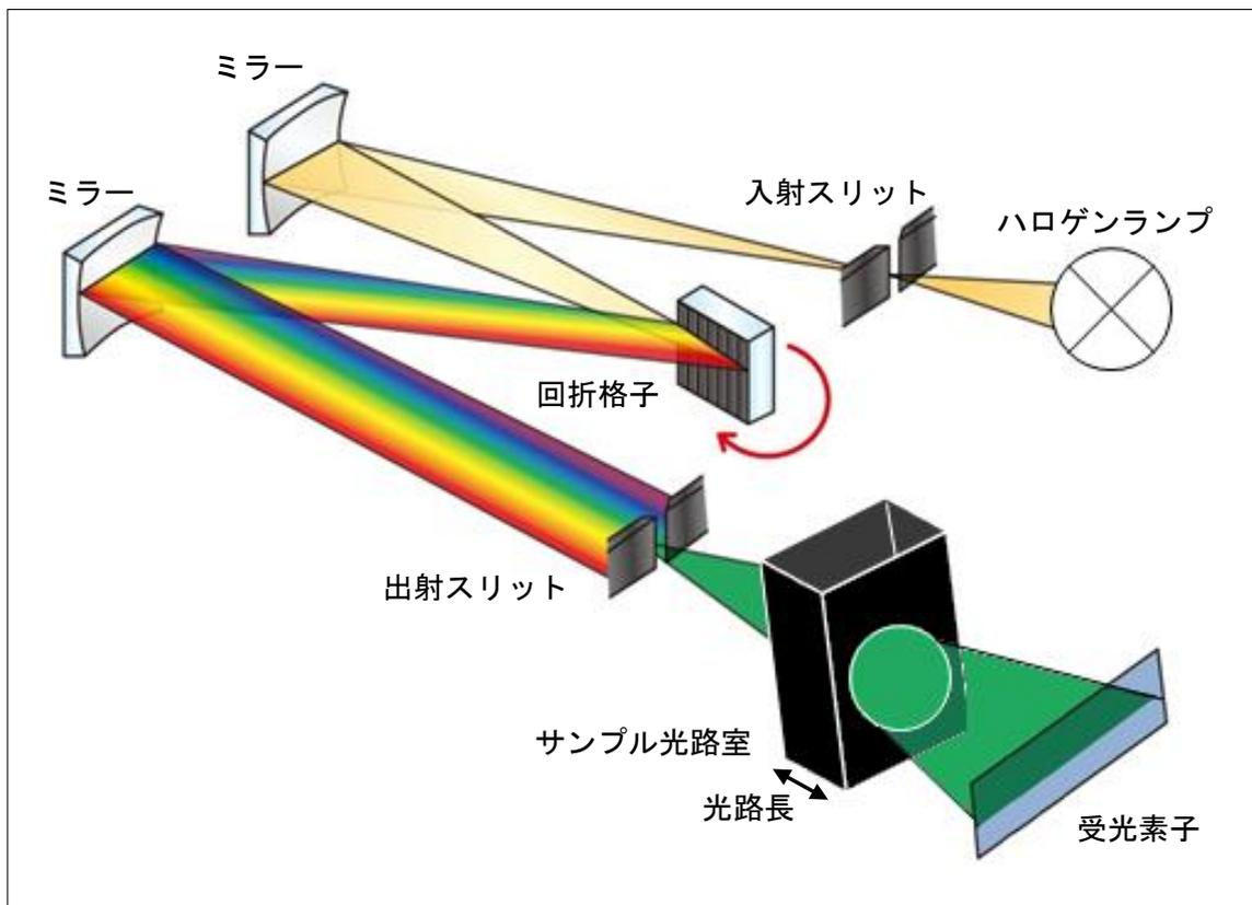
近赤外光は上図のようにサンプル光路室内のサンプルを透過します。
