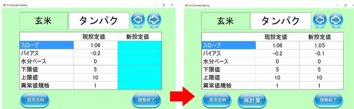
図 8.7.5 検量線設定画面（左：変更前 右：設定反映後）
