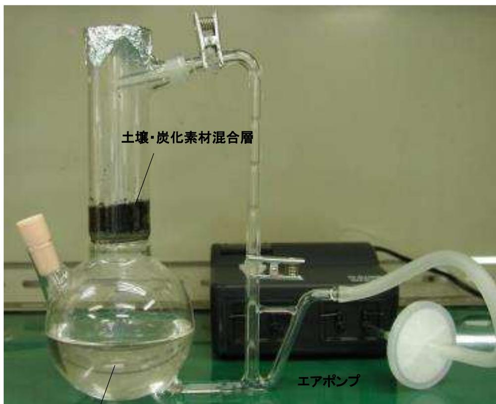
還流液(難分解性有機化合物を溶かした無機塩培養液)
