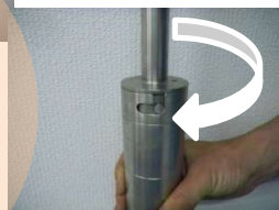
④ シャフトを採土管に接続する
