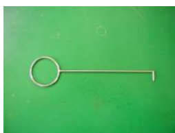
試料引揚治具 採取途中で引き揚げ る際に使用します。
