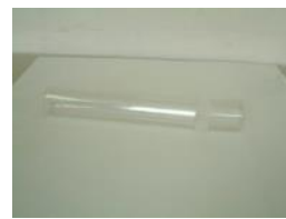
透明円筒（10 本） φ50×300mm, 250mm φ80×300mm, 250mm
